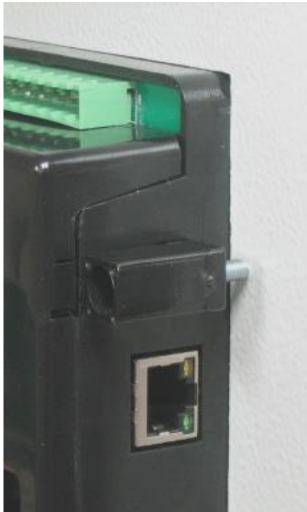
Instalación de la traba tipo tornillo
