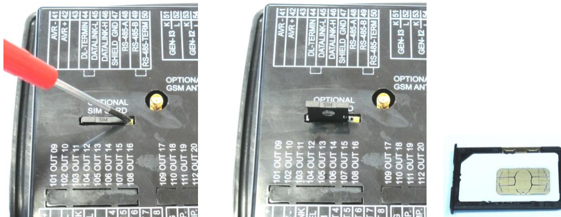
EXTRACCIÓN DE LA TARJETA SIM SIM CARD
